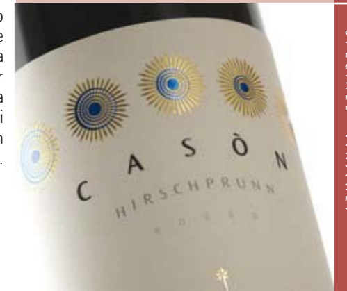
Per le etichette della linea Classici di Alois Lageder, sono state utilizzate diverse tecniche di stampa: colori metallizzati flexo e lamina a caldo, colori offset e vernice ad alto spessore, su un tipo di carta con effetto vergatura, ma patinata per la migliore restituzione dei colori e con una struttura adatta a una fustellatura molto particolare. Grazie anche a queste caratteristiche, è stato possibile valorizzare la matericità dei frottagge di Airò, la delicatezza degli acquerelli di Vitone e la luminosità della Hoelzl, alcuni degli artisti coinvolti nel progetto.
